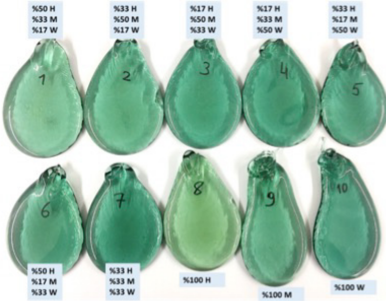
Şekil 1. Farklı fazlarda demiroksit içerikli hammadde ile deneyi yapılmış cam numuneleri
