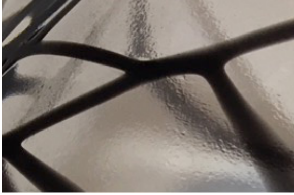
Şekil 7. Denizli Cam'da üretilen kurşunsuz siyah çubuğun alev parlatmalı ürün üzerindeki görseli
