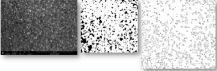
Şekil 4. AR kaplamalı sandy desenli cam numunesinin SEM görüntüsünde gözeneklilik hesaplaması yapılırken referans alınan bölge ve bu bölgeden elde edilen sinyal şiddeti haritası ve haritadan elde edilen verilerle oluşturulan gözenek alansal alan yüzdesi.
