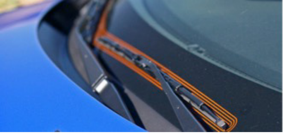
Resim 3: Silecek Bölgesi, Gümüş Baskılı Öncam
